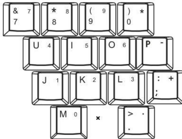
数字键方便您输入数字或做计算用。按下 **Fn+NumLk** 键后，屏幕右下角显示
