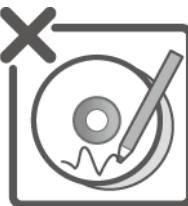
当手动弹出光驱时，请勿使用铅笔等易折断的物品，以免堵住紧急弹出孔。
