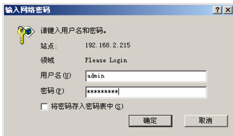
在用户名输入框中输入“admin”，然后在密码输入框输入“dbl#admin”（缺省），然后点击“确定”按钮，PC 上的浏览器会显示如下图所示的窗口，您已经成功地进入了 EP-848S 的网页 WEB 界面。
