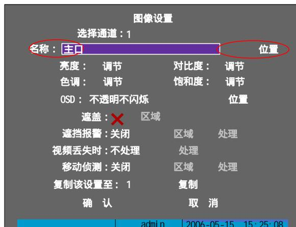
如果不显示通道名称, 只要将通道名称右侧的标示符设置成“x”。如果要显示通道名称, 可以对每个通道的显示位置进行设置。实际应用中, 一般每个通道具有一样的显示位置, 只要调整好一个通道的显示位置, 就可以方便地复制到其他通道上。以下介绍通道名称显示位置的调整方法。
