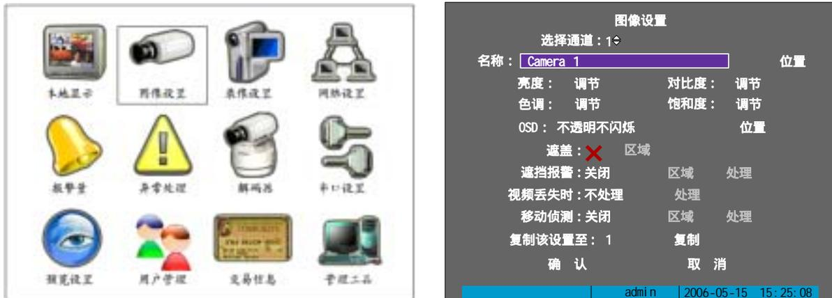
**编辑框：**提供一个字符输入的矩形框，通过【编辑/EDIT】键可以进入编辑状态，在编辑状态下，可以进行如下操作：通过【输入法/A】键可以切换输入字符的类型，包括数字、大小写英文字母、符号、中文；通过【→】【←】键可以移动光标位置；通过【编辑/EDIT】键可以删除光标前的字符；按【确认/ENTER】键或【退出/ESC】键可以退出编辑状态。
