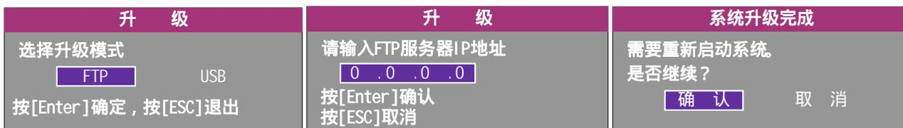
输入已配置好 FTP 服务器程序的主机 IP 地址，按前面板【确认/Enter】键，系统开始升级，系统会以消息窗的形式通知用户升级过程。如果选择 USB，请先确认 USB 设备已经正确连接在 USB 口上，同时升级程序已经拷贝在 USB 设备的根目录中。升级成功后，屏幕出现重启提示框，如图。设备重新启动后，系统启用新的软件。
