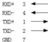
标准 RS-485 串口 RJ45 插座引脚定义
