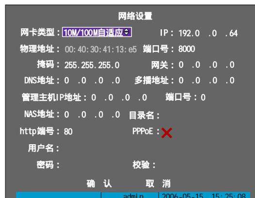
**NFS IP:** 输入网络存储服务器的 IP 地址, 按 “编辑” 键编辑。
