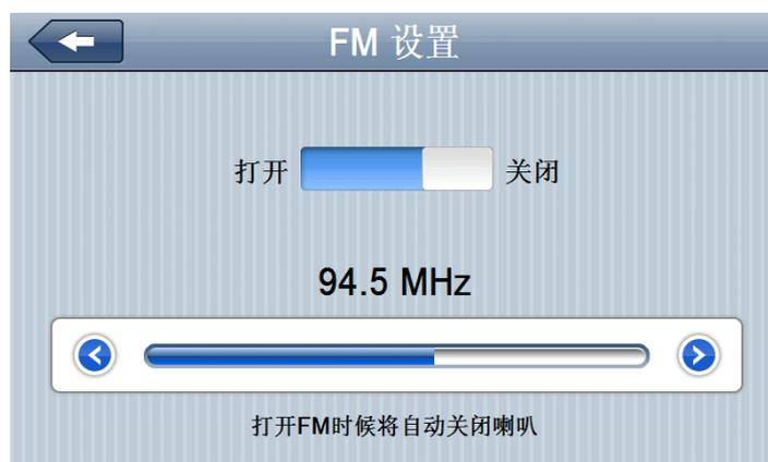
FM 发射是将本导航仪的音频信号通过该调频发射到收音设备，以 FM 某一频率（如图 94.5MHz）为例，此时必须调节导航仪发射频率和收音机接受频率一致，都为 94.5MHz，此时两设备处于同一频段，这样导航仪上的所有发声就会通过收音的功放系统输出。
