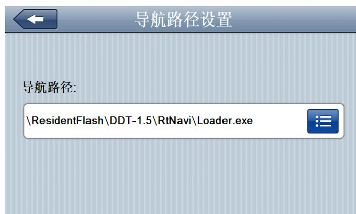
如果GPS导航仪中存在有两个或两个以上的地图公司的地图，使用此功能可以很方便的切换调用。
