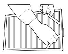
2.捏住前置过滤网边缘,将滤网边缘的突出部位对准过滤系统侧边的插孔,再弯曲另一侧,将前置过滤网完全装入。
