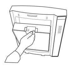
4.将前盖底部卡扣对准机身卡扣座,然后轻推前盖上端将前盖固定住。
