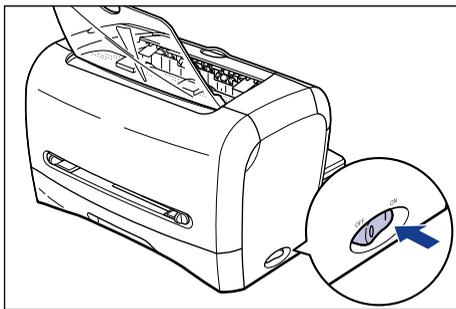
电源指示器变亮，打印机开始自我诊断测试。如果自我诊断测试中未发现任何异常，打印机就可开始打印了。
