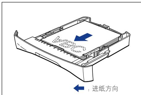
**6** 如图所示按下纸张，确保纸张没有超出装入限制标记且位于导纸器挂钩下方。
