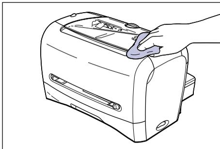
**3** 擦掉灰尘后，再用干布擦拭打印机。
