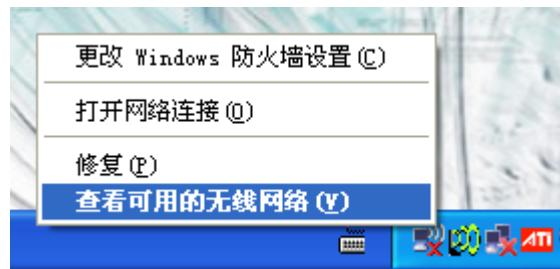
如果可用无线网络无法出现在无线网络连接窗口，请先至“更改高级设置”将“使用 Windows 配置无线网络设置”复选框勾选保存。
