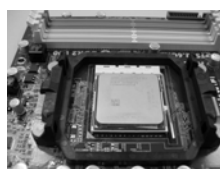
步骤 4： 下推并锁住插座拉杆
