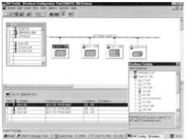
图 3-4 硬件配置, 包括分布式 I/O
