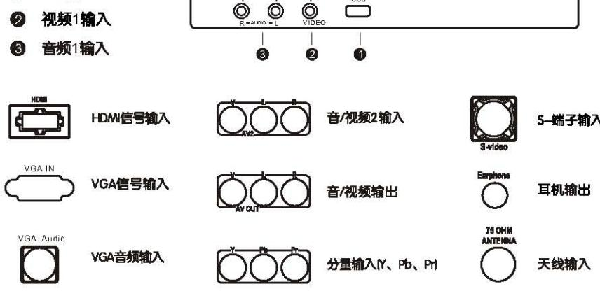
备注：1、视频2输入与分量输入共用音频输入端口，故二者不能同时使用。
