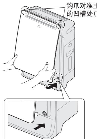
将突起部分牢牢地插入主机的孔(两处)中。
