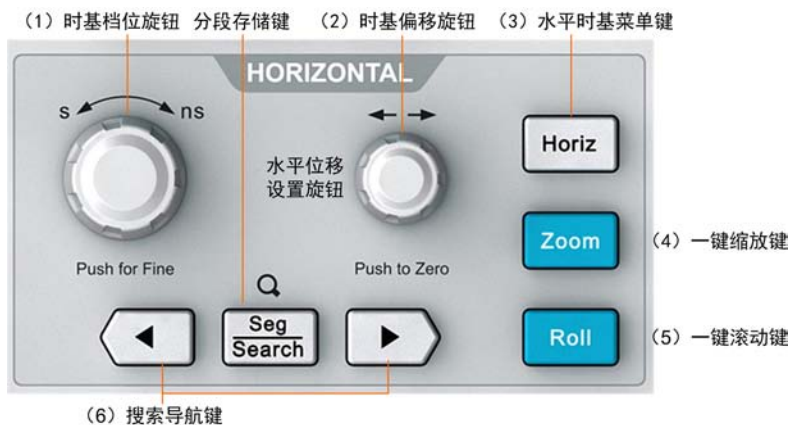
图 2.18 水平控制区（分段存储键暂未开放）
