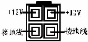
请特别注意，此 ATX\_12V 电源插座为提供 CPU 电源使用，若没有插上 ATX\_12V 电源插座，系统将不会启动。
