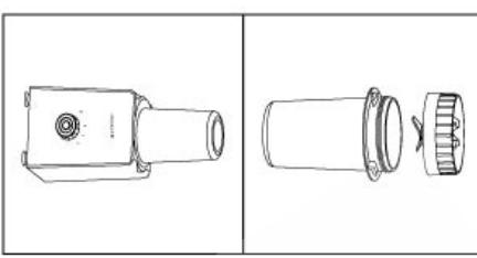
2. 将搅拌刀座与调理杯旋紧；顺时针将卡口拧紧在主体上。
