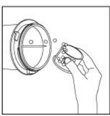
1. 将搅拌刀座与调理杯旋紧；顺时针将卡口拧紧在主体上。
