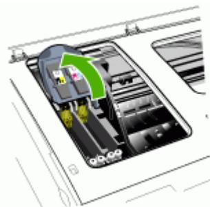
4. 抬起要更换的打印头的手柄，将打印头从插槽中拉出。
