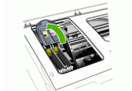
4. 提起打印头手柄，并利用它将打印头从槽中拉出。
