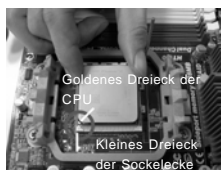
SCHRITT 2 / SCHRITT 3: Richten Sie das goldene Dreieck der CPU mit dem kleinen Dreieck der Sockelecke aus
