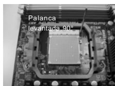
PASO 1: Levante la Palanca del Zócalo
