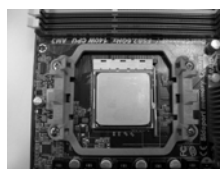
FASE 4: Abbassare e bloccare la levetta socket
