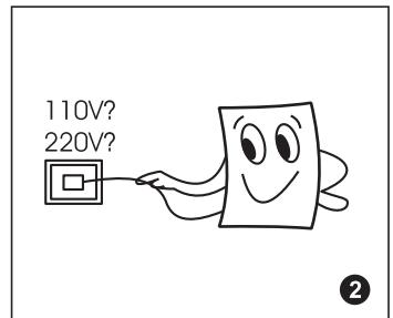
**②** 冷氣機必須使用專用插座及回路，並確認是否合乎該冷氣機所使用之電源電壓，且需使用運轉電流1.5倍容量之保險絲或無熔絲開關。
