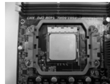
步骤 4： 下推并锁住插座拉杆
