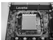
FASE 1: Sollevare la levetta socket
