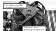
(Fori per fastener che allineati ad fori passanti)
