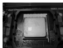
步骤 4： 下推并锁住插座拉杆
