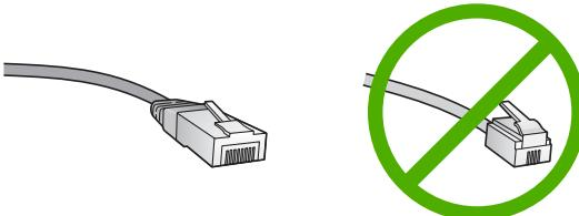
虽然标准的以太网电缆看起来与标准的电话电缆相似，但它们是不可互换的。每种电缆中的导线数目不同，并且每种电缆的接头也不同。以太网电缆的接头（也称作 RJ-45 接头）较宽且较厚，其末端总是有 8 个触点。电话接头有 2 到 6 个触点。
