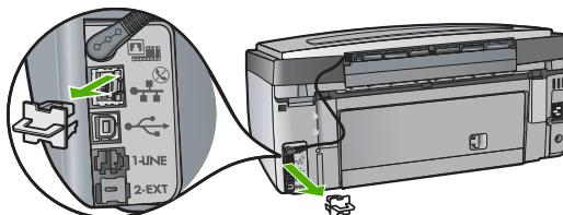
2. 将以太网电缆连接到 HP All-in-One 背面的“Ethernet”（以太网）端口。
