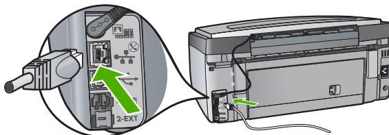
3. 将以太网电缆的另一端连接到以太网路由器或交换机的可用端口上。
