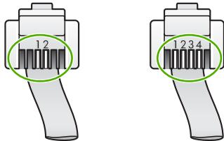
如果使用的是 4 芯电话线，请将其断开，然后将提供的 2 芯电话线连接到 HP All-in-One 背面带有 1-LINE 标记的端口中。
