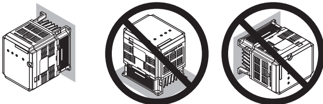
图 6 安装方向（例：制动单元）
