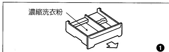
● 安裝方法 - 從斜上方輕輕地裝入後，筆直地推進去。
