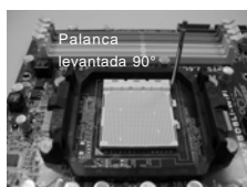
PASO 1: Levante la Palanca del Zócalo
