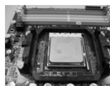
FASE 4: Abbassare e bloccare la levetta socket
