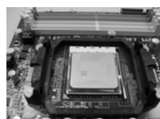
步驟4： 下推並鎖住插座拉桿
