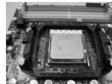
SCHRITT 4: Drücken Sie den Sockelhebel nach unten und rasten Sie ihn ein
