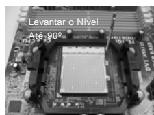
PASSO 1: Levantar o Nível de Tomada Até 90°
