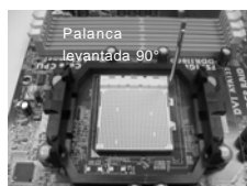
PASO 1: Levante la Palanca del Zócalo
