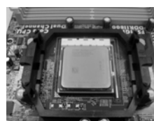
SCHRITT 4: Drücken Sie den Sockelhebel nach unten und rasten Sie ihn ein
