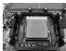
FASE 4: Abbassare e bloccare la levetta socket
