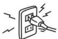
電源插頭不完全插入插座內，請勿使用。不完全插入插座內時，會發生發熱、火災或觸電等事件。
