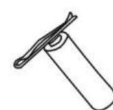
請勿將電池分解，加工（焊接等）、加壓、加熱或投擲至火堆中
