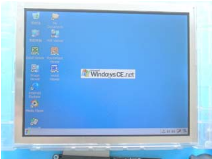
图 3-7 打开电源开关，等几秒钟，出现 WindowsCE 开机画面
