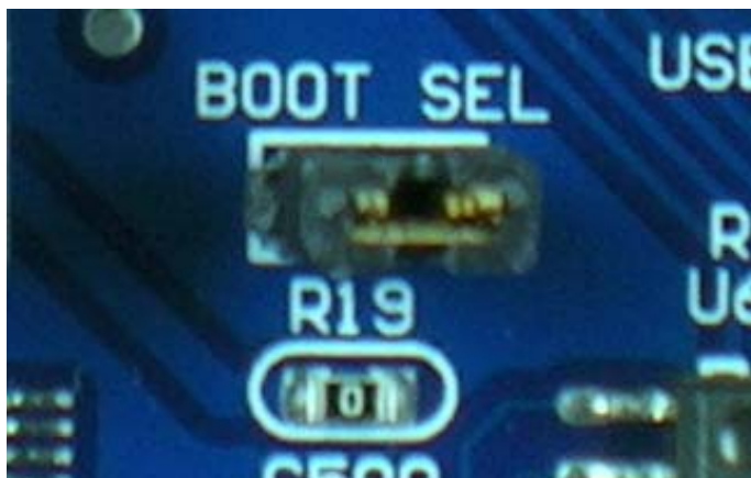
图 3-5 BOOT SEL 短接表示选择 Nand Flash 启动
