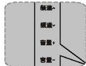
按下电视机上的频道增减键也可切换频道（音量的增减，请按音量增减键）
