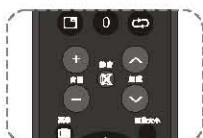
按下遥控器上的节目增减键即可切换频道（音量的增减，请按音量增减键）
