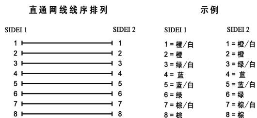
图4-2 直通网线制作示例图
