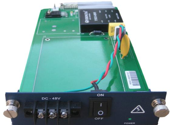
**直流电源接头: DC-48V**
