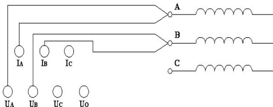
接好被测绕组接线，选择合适的测量电流后，按“测量”键，直阻仪进入测量状态，开始给绕组供电。并进入如下界面：
