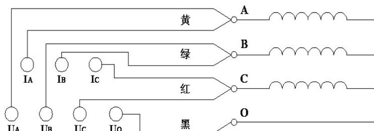
选择好测量电流，接好三相接线，在初始界面状态下按“测量”键后，直
