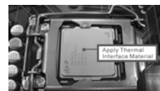
(Applicare il materiale dell'interfaccia termica)
