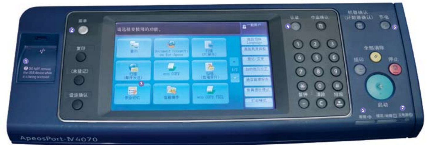
1 U盘闪存插槽 2 菜单按钮 3 8.5"彩色用户界面 4 认证按钮 5 状态指示灯 6 节电按钮 7 主电源指示灯
