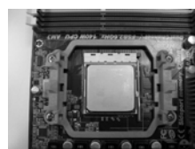
FASE 4: Abbassare e bloccare la levetta socket
