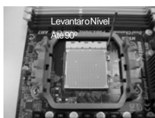
PASSO 1: Levantar o Nivel de Tomada Até 90°
