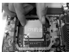
步骤 2 / 步骤 3： 将 CPU 的金三角对准插座 边角上的小三角
