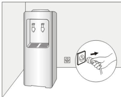
※ 若长时间不使用本机，请把电源插头拔掉，并通过排水口将机内余水全部放完。当电器处于冰点以下环境，导致机器出现冰堵情况时，需关闭制冷开关4小时后，才能打开制冷开关继续工作。
