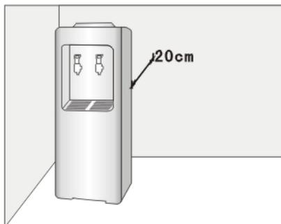
※ 将饮水机放于室内阴凉干燥的稳定的平面，且底部不能垫泡沫、纸板等杂物，以免水分积聚而导致漏电。并避免阳光直射。机身背面与墙壁不少于20cm的距离，机器旁禁止放置易燃物品。该机不适用于户外或在可能有水喷溅的地方使用。
