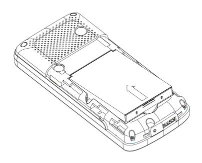
警告: 拆卸电池之前一定要将手机关机。绝对禁止在开机的情况下直接取出电池,否则可能损坏 SIM 卡和手机。
