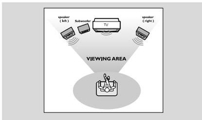
为了获得尽可能最佳的环绕声效果，应按以下方式摆放扬声器和重低音扬声器。
