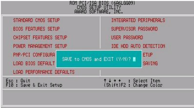
圖 4.12: 離開SETUP並儲存設定結果
