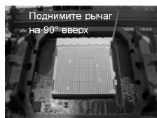
ШАГ 1. Поднимите рычаг гнезда.
