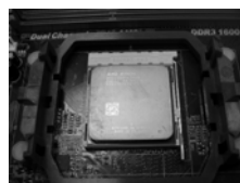
ШАГ 4. Прижмите и зафиксируйте рычаг гнезда.
