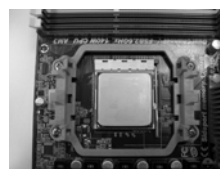
步骤 4： 下推并锁住插座拉杆
