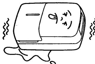
機體側放致使水溢出，容易損壞故障
