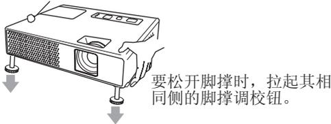
要松开脚撑时，拉起其相同侧的脚撑调校钮。
