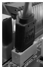
将 SATA 数据线连接到 eSATAII 接口 (eSATAII_TOP)
