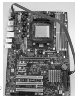
将 SATA 数据线连接到 eSATAII 接口 (eSATAII_TOP)
