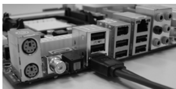
将 eSATAII 设备连线的另一端连接到 I/O 挡板的 eSATAII 设备
