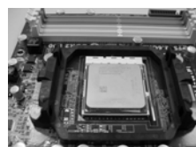
步骤 4: 下推并锁住插座拉杆
