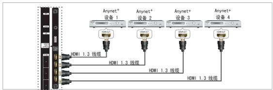
使用HDMI电缆将电视机上的[HDMI 1 (DVI)], [HDMI 2], [HDMI 3]或[HDMI 4]插孔与相应 Anynet+ 设备的 HDMI 输出插孔连接。
