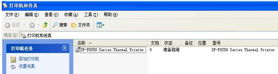
右键点击所安装的 SP-POS58 Thermal Printer 打印机图标, 打开属性窗口。
