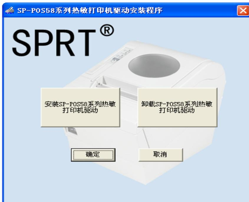
点击“安装 SP-POS58 系列热敏打印机驱动”
