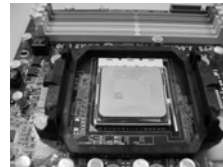
步骤 4： 下推并锁住插座拉杆
