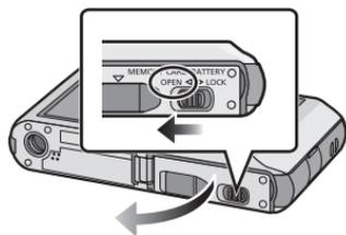
**2** 电池：注意电池方向，完全插入直到听到锁住的声音为止，然后确认是否被开关 **(A)** 锁住。要想取出电池，请朝箭头指示的方向滑开开关 **(A)**。
