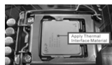
(Applicare il materiale dell'interfaccia termica)
