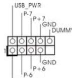
除了位于 I/O 面板的四个默认 USB 2.0 接口之外，这款主板有两组 USB 2.0 接针。这组 USB 2.0 接针可以支持两个 USB 2.0 接口。
