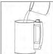
请将水加至上、下水位刻度线之间。（本机具有无水防干烧功能，如杯体内无水或水位过低，机器不会工作，以保证使用安全。）
