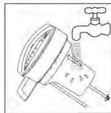
1. 机头：请用水轻轻洗去机头下部粘附的豆浆或其它残留，切勿将机头浸入水中，也不要用水清洗机头上部，以防止机头进水，发生短路现象。
