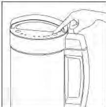
请将机头按正确的位置放入杯体中，插上电源线，功能指示灯全亮，按下“选择”键，选择所需的功能，对应指示灯亮，按“启动/取消”键启动相应的制作程序。
